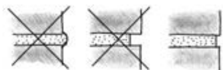
Le profil des nouveaux joints doit correspondre à celui des anciens : peu épais, ni en creux, ni en saillie.
