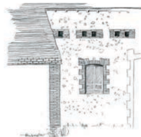
Maçonnerie mixte, enduit et brique : - tuiles plates en terre cuite, - chaîne d'angle et encadrements de baie en brique, - enduit à pierre vue en arrière plan, - enduit couvrant au premier plan.
