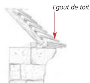
Les égouts de toiture présentent une rupture de pente ici créé par la superposition de tuiles sur la corniche.
