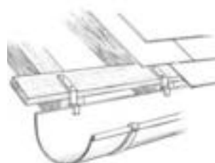
Gouttière pendante posée en débord et sous l'égout de toit.
